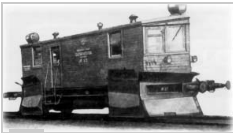
Плуговой однопутный снегоочиститель. 1935 г.
