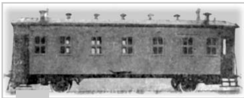
Двухосный вагон IV класса для переселенцев на 40 мест
