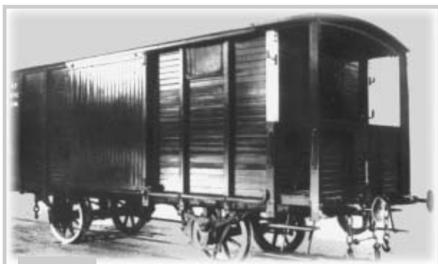
Двухосный крытый тормозной вагон грузоподъемностью 12,5 т постройки 1892 г.
